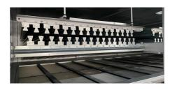
无张力喷咀型烘干装置有空气喷咀, 上下喷咀的间隙高度可调,有助于织 物收缩工序
